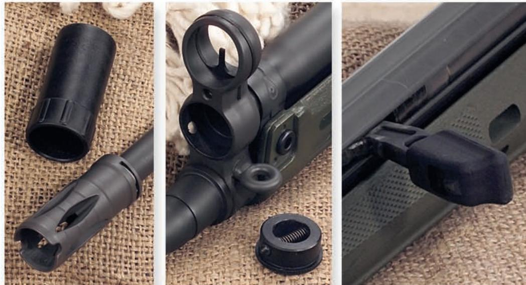
Oben (v.l.): Neben dem Mündungsfeuerdämpfer befindet sich die dazugehörige Abdeckkappe. Ganz im Stil des G 3 hat das SAR Sportmatch einen Korntunnel mit einem stiftförmigen Korn. Daneben die Abdeckung des darunter liegenden Hohlraums. Rechts: Der nach vorn anlenkbare Durchladehebel des Sportmatch lief – wie auch beim G 3 üblich – auf einer recht strammen Feder.
