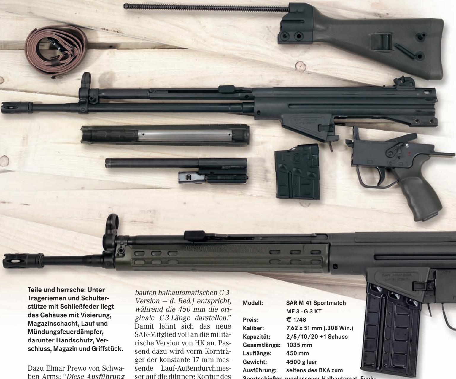
**Teile und herrsche:** Unter Trageriemen und Schulterstütze mit Schließfeder liegt das Gehäuse mit Visierung, Magazinschacht, Lauf und Mündungsfeuerdämpfer, darunter Handschutz, Verschluss, Magazin und Griffstück.
