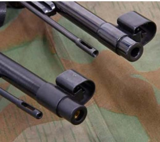
Blick auf die Mündungen mit darüber liegendem Korn mit Schutztunnel: Oben .308er, unten 6 mm BB.
