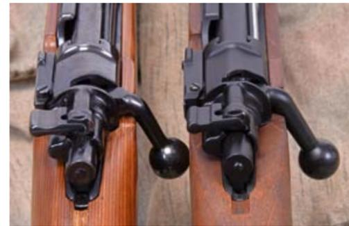
Original und Fälschung: Blick auf die Verschlusskammern mit Schösschen und Dreistellungs-Sicherung der .308er (links) und der 6 mm BB (rechts).
