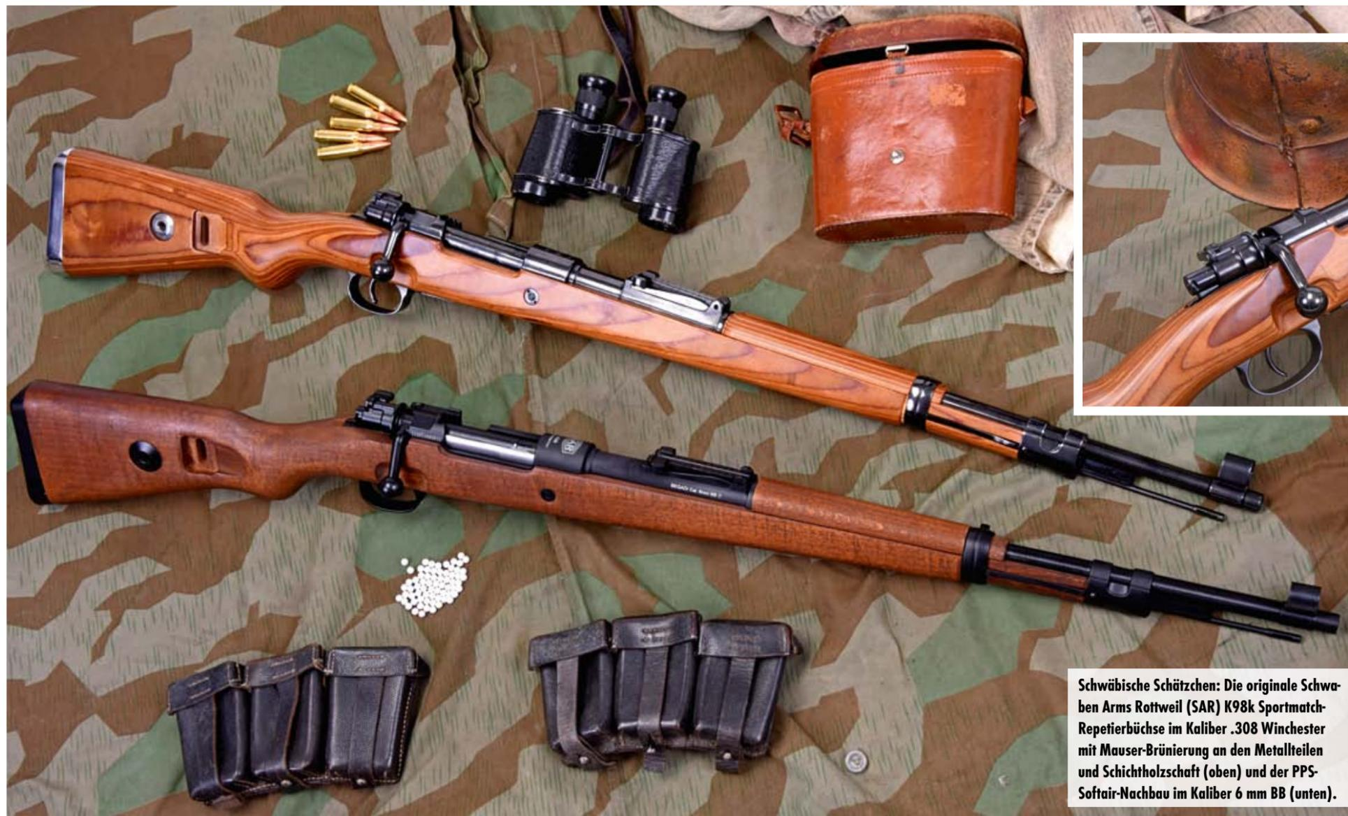
Schwäbische Schützen: Die originale Schwaben Arms Rottweil (SAR) K98k Sportmatch-Repetierbüchse im Kaliber .308 Winchester mit Mauser-Brünierung an den Metallteilen und Schichtholzschafft (oben) und der PPS-Softair-Nachbau im Kaliber 6 mm BB (unten).
